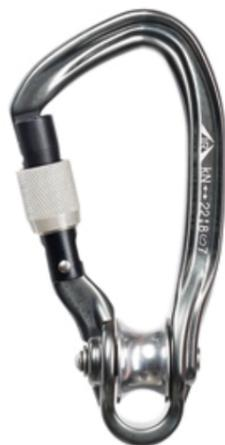
Карабин с роликом "Пингвин-автомат" может использоваться и как соединительное звено, и как вспомогательный блок-ролик в различных полиспастных системах, а также в любых системах, где веревка меняет направление, минимизируя потери на трение.
